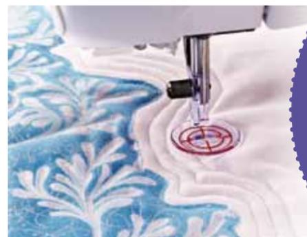
Das Geheimnis ist die große Grundfläche des Fußes. Sie sorgt für perfekten Kontakt mit dem Stoff und erhöht so die Kontrolle beim Nähen. Der durchsichtige Fuß erlaubt optimale Sicht für genaues Arbeiten. Dank vertikaler, horizontaler und kreisrunder Markierungen lassen sich beim Quiltten Musterlinien leicht verfolgen. Egal ob gerade Linien oder Rundungen an Ecken – Sie nähen einfach und problemlos in jede Richtung.
