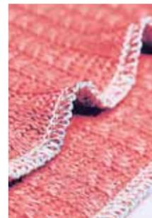
Dank Differentialtransport dehnt sich der Stoff nicht aus. Bei entgegengesetzter Einstellung entsteht der modische Welleneffekt.
