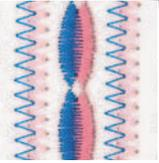
**Zwillingsnadel** Bei der Zwillingsnadel (Doppelnadel) sind zwei Nadeln an einem Schenkel befestigt. Sie wird für Zier- und Steppnähte sowie Biesen verwendet. Zwillingsnadeln gibt es in verschiedenen Nadel-Abständen.
